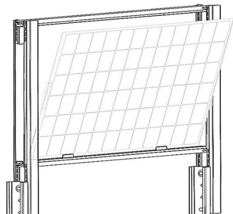
Darauf achten, dass das längere Kabel (+) unten und das Kürzere (-) oben ist. Die Rückseite vom Modul auf die gewünschte Seite geben (dort wo die kleinen Anschlussdosen sind). Diese Seite bringt etwas weniger Nennleistung mit, je nach Modultype bis zu 15%.
