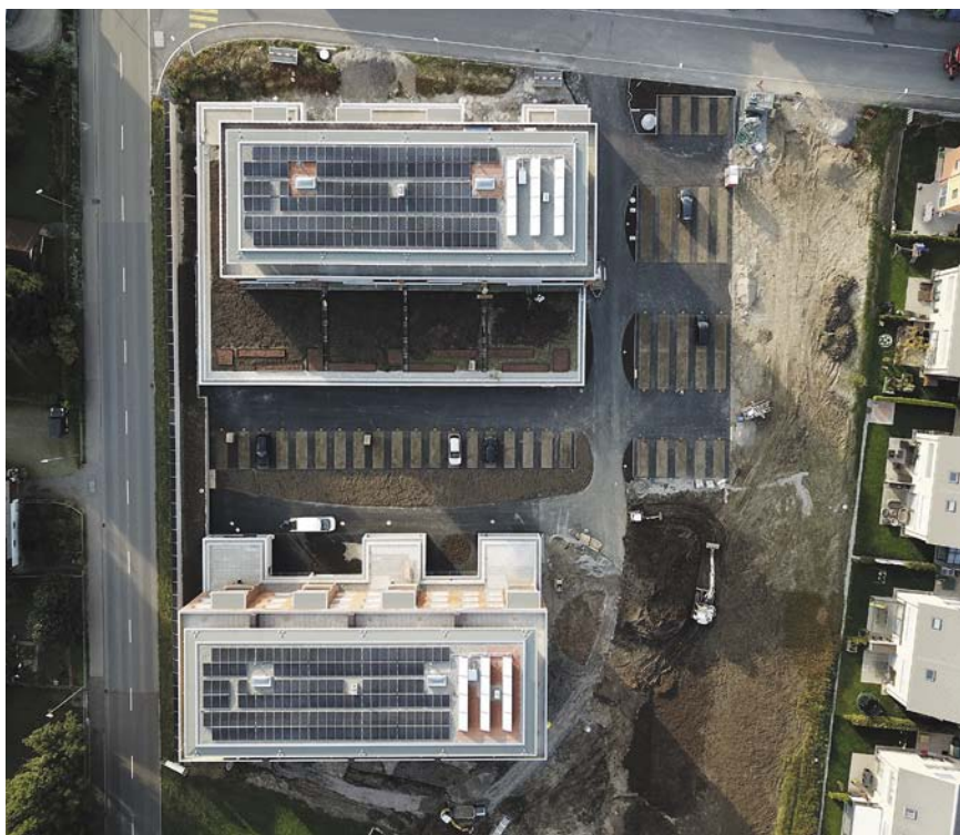
Die auf den Dächern mit Ost-West-Ausrichtung montierten Module leisten kumuliert 43 Kilowatt
